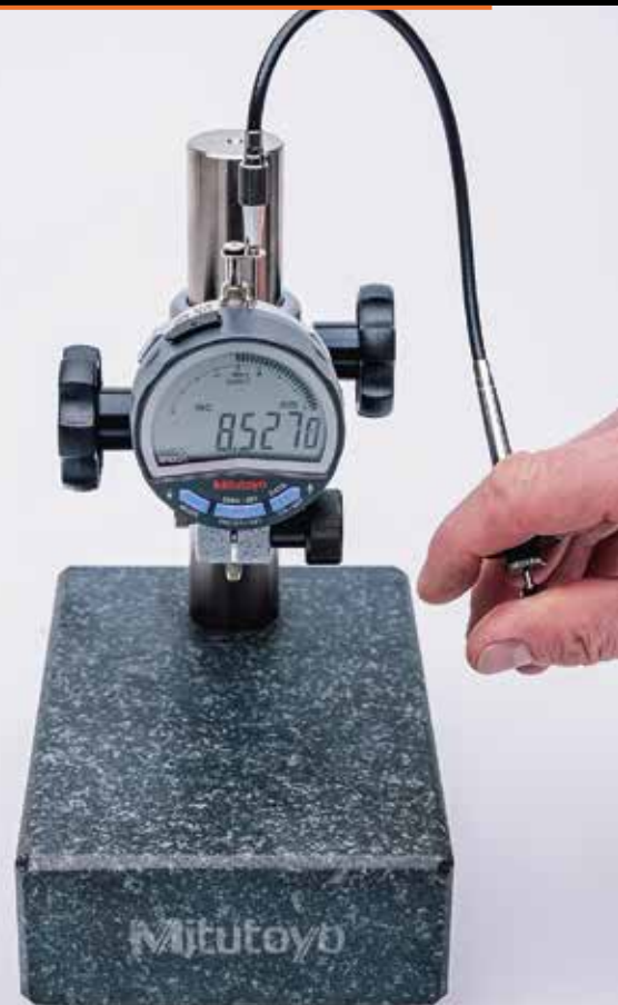
Sovellus, jossa on karan nostokaapeli ja graniittijalusta
