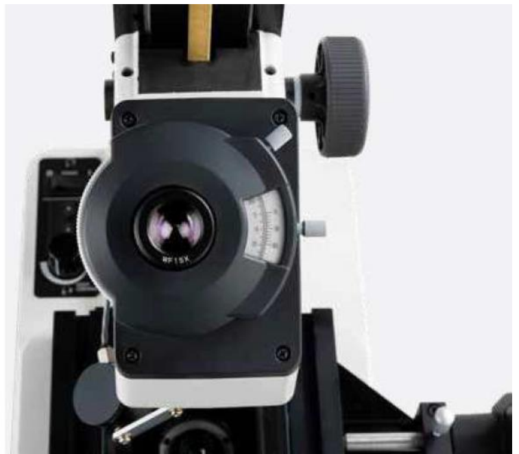
Okulaarin ulkopuolelle asennettu noniusasteikko mahdollistaa yksinkertaisen kulman mittaamisen.
